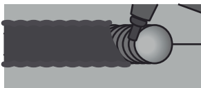
Escória na parte esquerda, e o cordão de solda por baixo dela na parte direita
